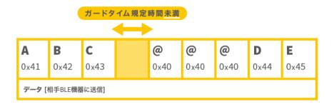
アドバタイズ状態からアドバタイズエスケープ状態に移行する場合もガードタイム経過後に@@@を 3 回連続で送信してください。
